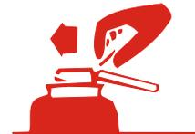
**3.** Kurz auf den Druckhebel oder Schlagknopf drücken, Handgriff anheben bzw. Handrad der CO<sub>2</sub> Flasche nach links drehen.
