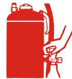
**4.** 2 - 3 Sekunden warten, da das CO<sub>2</sub> in den Behälter strömt: Der Feuerlöscher ist jetzt „einsatzbereit“.
